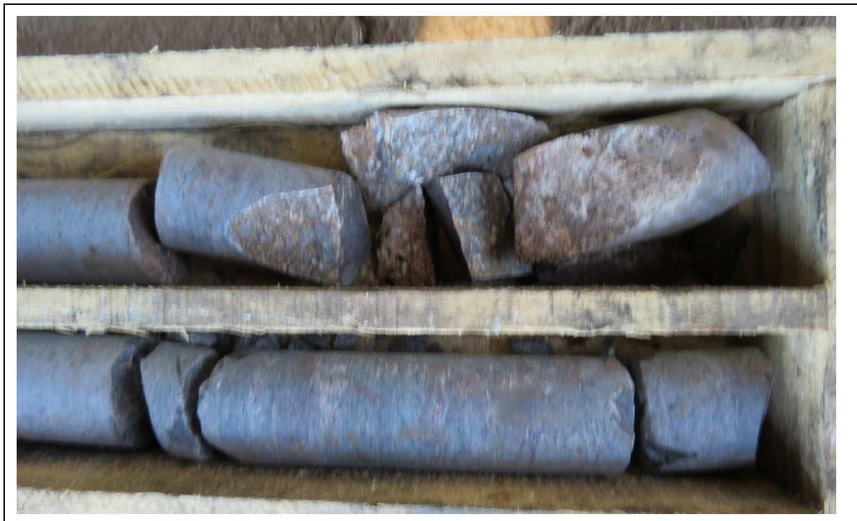
Fotografia 3 – Perfil litológico Furo Sondagem SR 01 – Fratura inclinada entre 0,70 e 0,90 m
