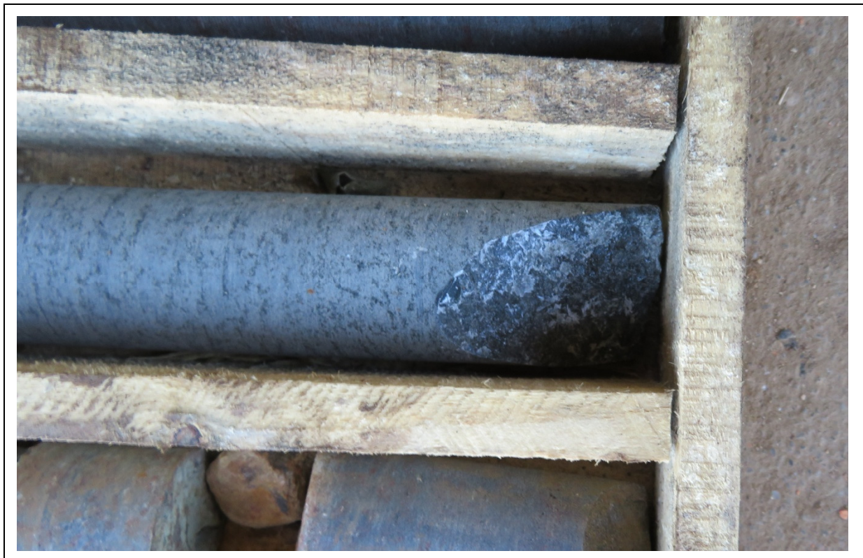
Fotografia 5 – Perfil litológico Furo Sondagem SR 01 – Fratura inclinada na profundidade de 3,64 m
