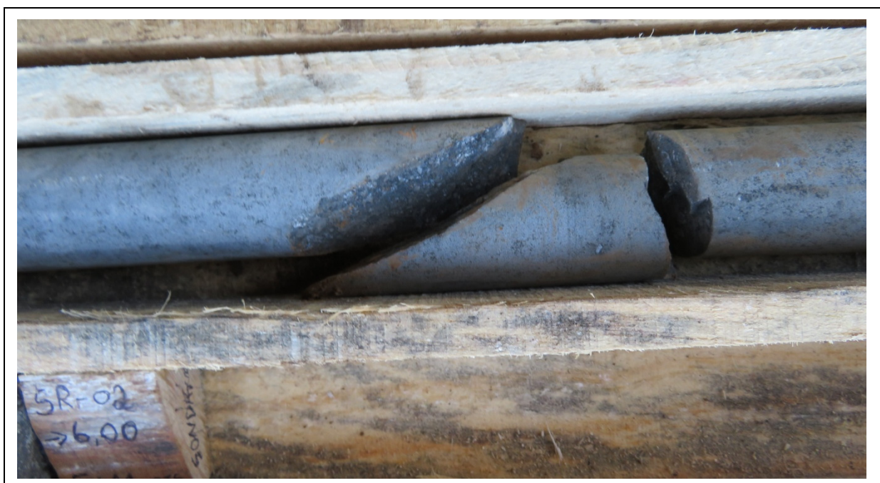
Fotografia 6 – Perfil litológico Furo Sondagem SR 01 – Fratura inclinada na profundidade de 5,20 m
