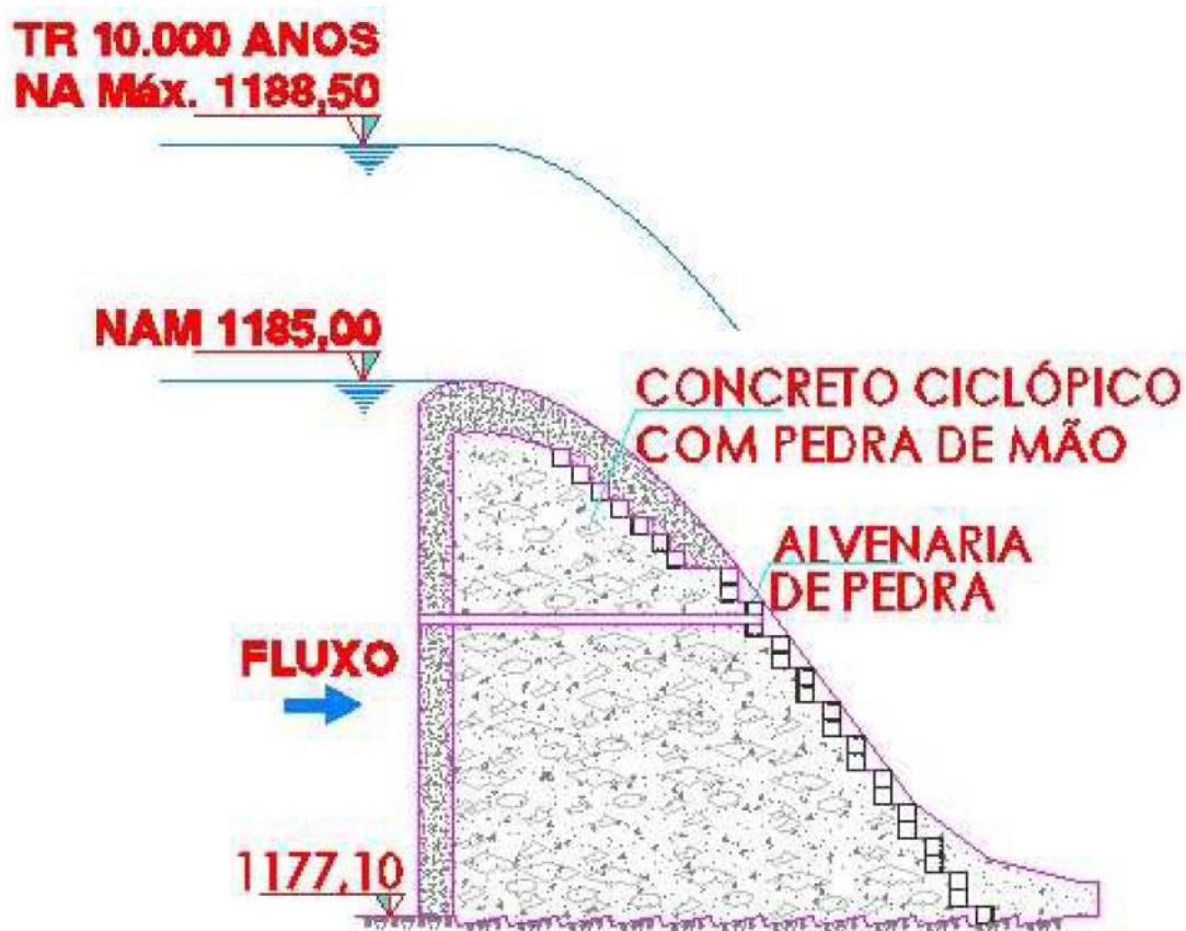
Figura 54 – Seção Transversal do Barramento
