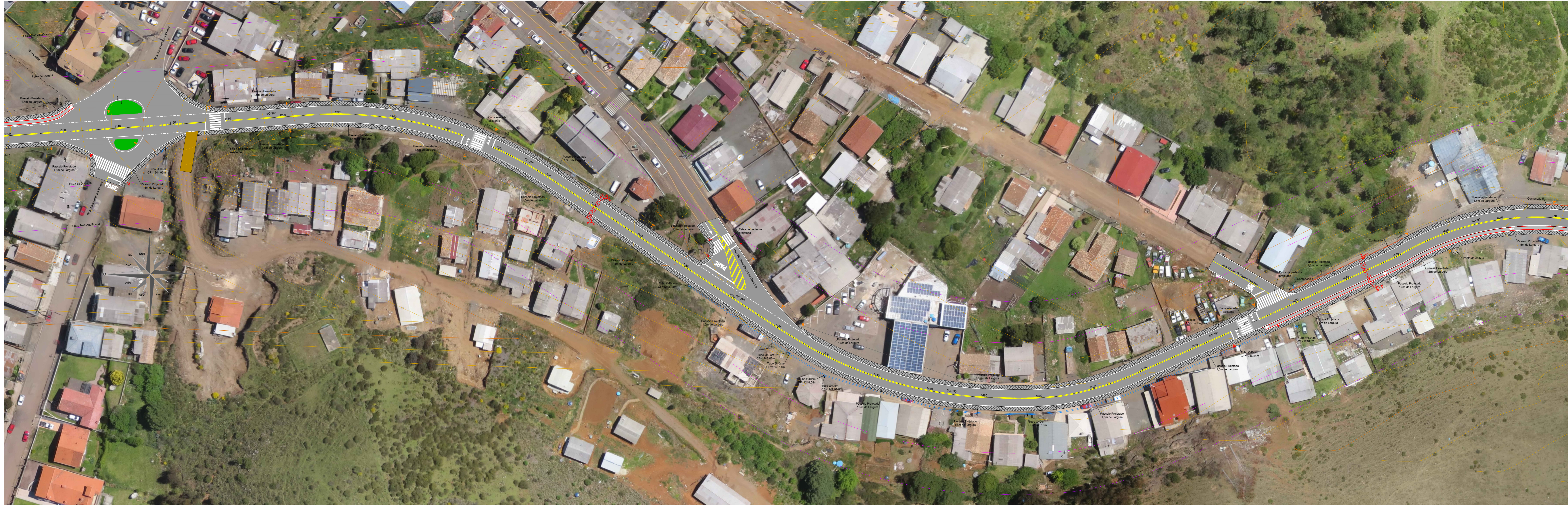
PLANTA DE SINALIZAÇÃO VIÁRIA Eixo 1.700m até 2.100m Escala 1:500
