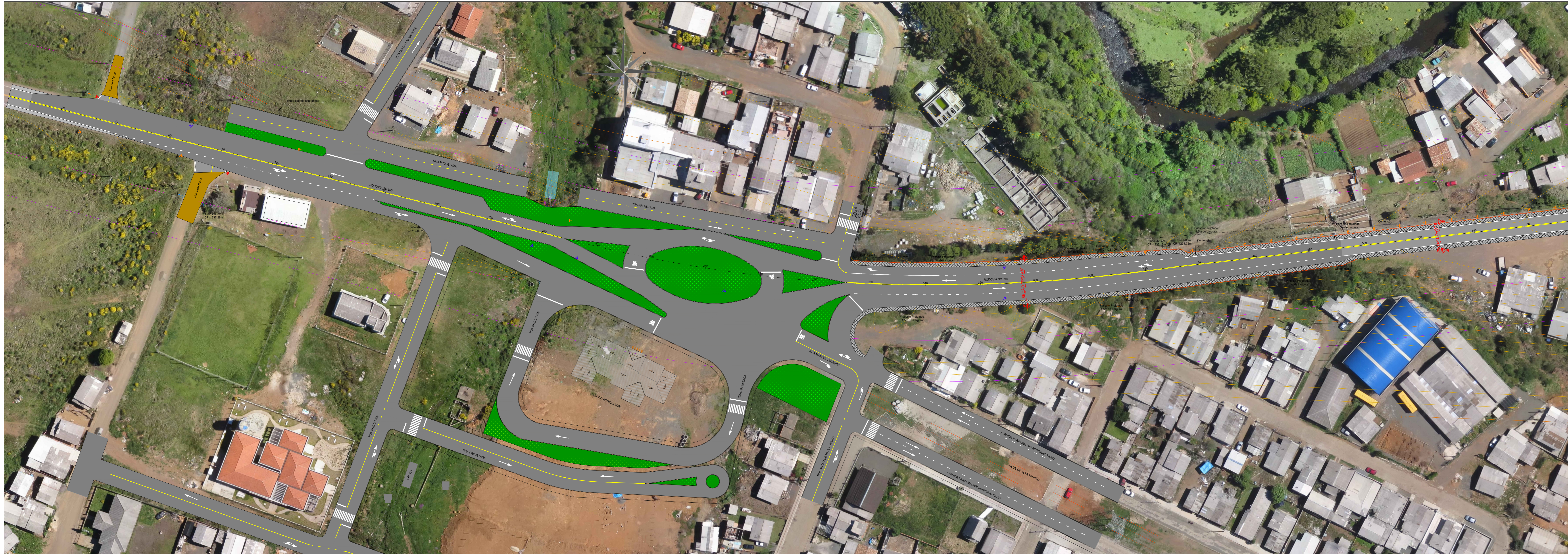
PLANTA DE SINALIZAÇÃO VIÁRIA Eixo 570,0m até 1.140,0m Escala 1:500
