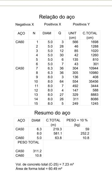
Armação negativa das lajes do pavimento Cobertura (Eixo X)
