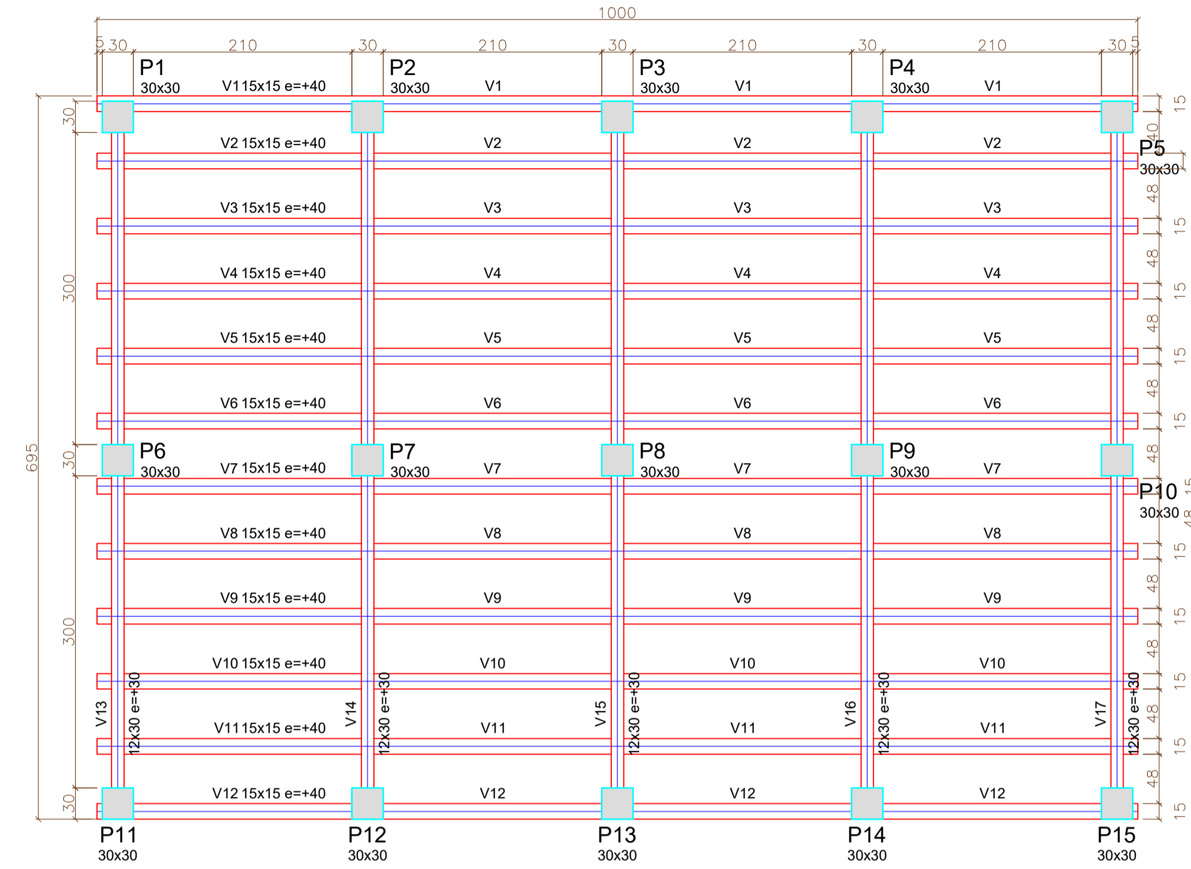
Forma do pavimento Deck escala 1:50
