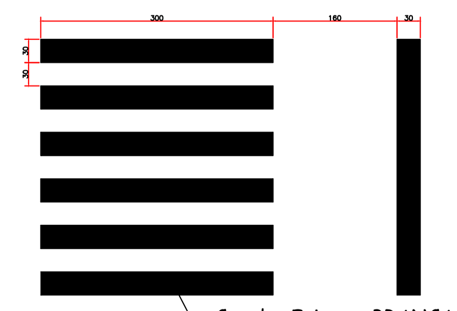
DETALHE 03 - FAIXA DE SEGURANÇA PARA PEDESTRE ESCALA 1:50
