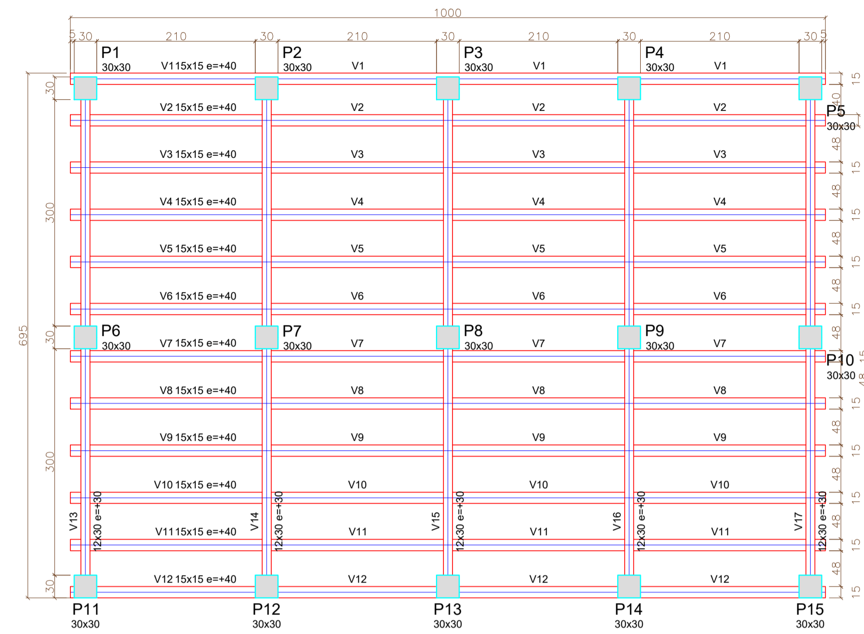
Forma do pavimento Deck escala 1:50
