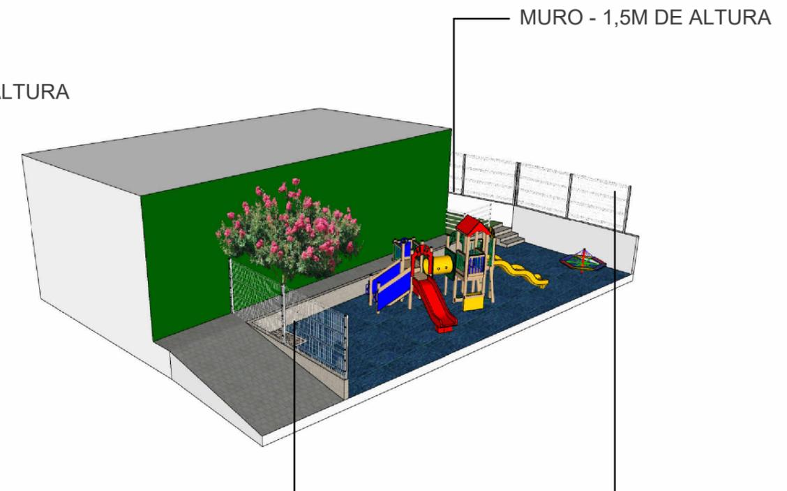
Altura do gradil: Variável conforme o projeto (normalmente entre 1,2 m e 2 m).
