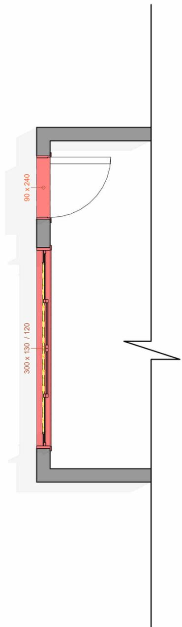
Instalação de porta Blindex com dimensões de 90x240 cm, vidro temperado com espessura de 8 mm, acabamento incolor (ou especificar outra cor se necessário), incluindo ferragens em aço inox (ou alumínio) e sistema de fechamento padrão
